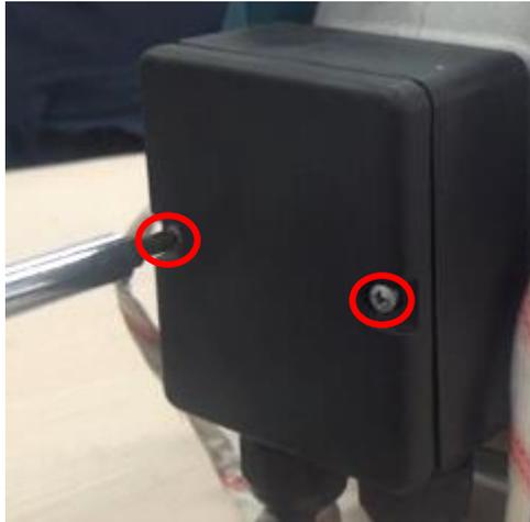
3. 用十字螺丝刀松开接线柱上的两件螺钉，整体卸下接线盒组件。
