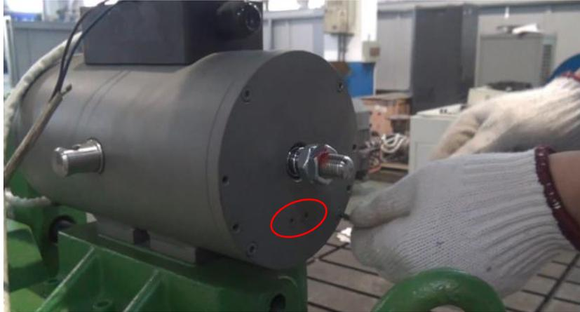
3. 将微动开关支架（包括微动开关）装上制动器静铁芯，用两件螺钉 M4 紧固。
