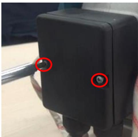
7. 在静铁芯两端装上微动开关组件，用螺钉 M4 和垫圈紧固（两端）。
