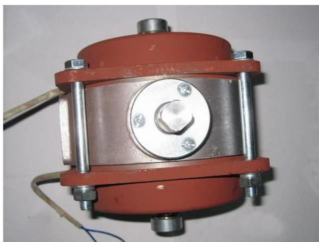
5. 将接线盒组件按原样装回制动体，用十字螺丝刀紧固接线柱上的两件螺钉。
